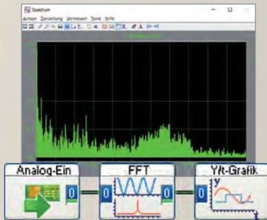
Mit **drei Modulen** zu einem Oszilloskop mit FFT-Signalauswertung.
