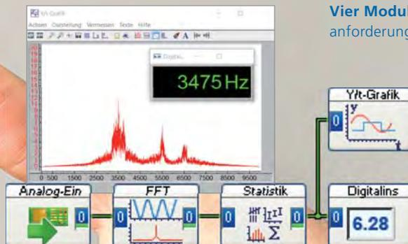
**Fünf Module** für die Datenerfassung mit FFT-Signalauswertung, Statistikfunktion und Ergebnisdarstellung.
