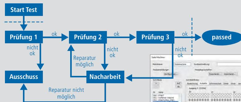
Bei konventionellem Aufbau einer Schritt-kette in DASYLab werden alle Module immer gleichzeitig parallel abgearbeitet – insbesondere auch die Teile der Schritt-kette, die eigentlich aktuell nicht benötigt werden. Im State-Machine-Modul wird demgegenüber nur der aktive Teil der Schritt-kette bearbeitet, da alle Entscheidungen über den Arbeitsschritt in einem einzigen Modul gefällt werden. Rechenzeit und Speicherbedarf werden dadurch erheblich verringert.
